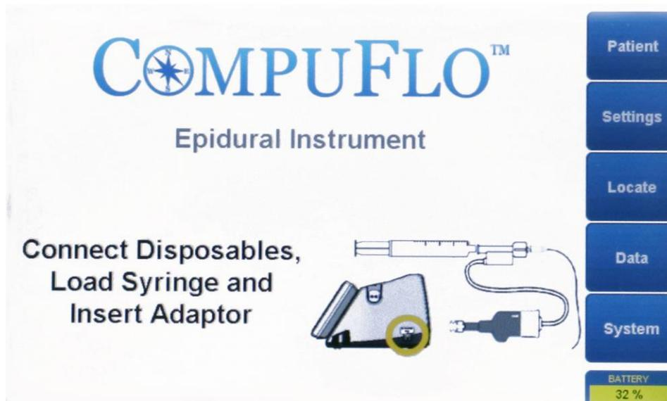
**Connecter le matériel jetable, charger la seringue et insérer l'adaptateur ID :** Connectez l'adaptateur ID en série/le capteur de pression en ligne externe à la seringue. Placez la seringue chargée dans la plate-forme et branchez le côté prise de l'adaptateur ID de l'ensemble en série dans l'instrument.
