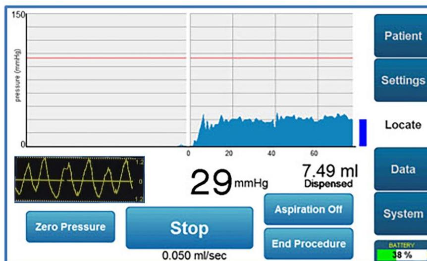
Dans la zone bleue de la procédure, le système CompuFlo® Epidural dispense la solution saline au débit défini par l'utilisateur. L'espace périuridral est localisé lorsqu'une chute de la valeur de pression en-dessous du seuil minimum est observée pendant au moins 5 secondes.
