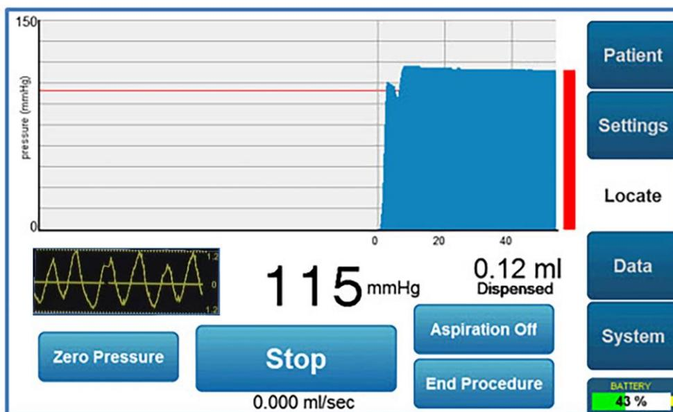
Dans la zone rouge de la procédure, le système CompuFlo® Epidural détecte la pression supérieure au seuil de pression haut défini par l'utilisateur. Le système ne dispense pas de solution saline avant que la pression ne chute dans la zone jaune ou bleue.
