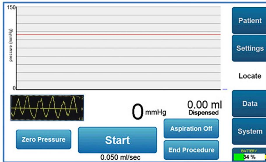
Le flux de solution saline peut commencer en appuyant sur le bouton Start (Démarrer) sur l'écran LCD tactile ou en appuyant sur le bouton START du tableau de commande ou encore en appuyant sur la pédale.
