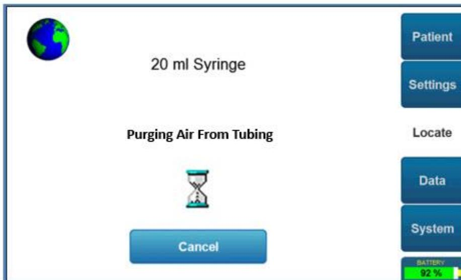
Le piston de la plate-forme avance après avoir détecté la seringue et amorce la tubulure.
