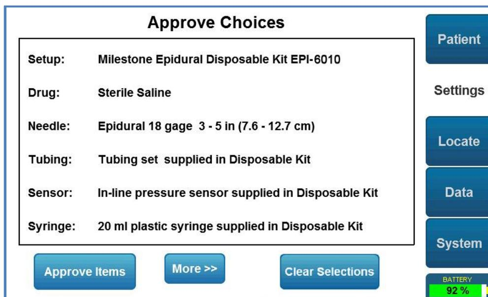
**Approvare la scelta degli strumenti:** La schermata sopra raffigurata consente di confermare la selezione dei parametri visualizzati sullo schermo premendo "Approve Items" nell'angolo in basso a sinistra (come mostrato sopra). Il pulsante "Clear Selections" permette di tornare alla schermata di selezione dell'ago per cambiare le dimensioni dell'ago usato nella procedura.
