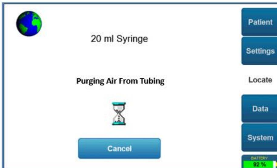
Lo stantuffo della piattaforma si sposta in avanti dopo aver rilevato la siringa e riempie il tubo.
