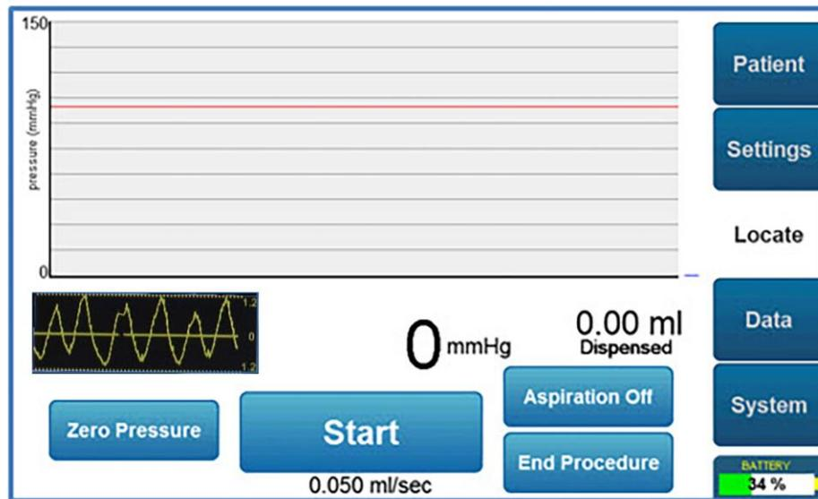
Il flusso di soluzione fisiologica può essere avviato premendo il pulsante START sul touchscreen dell'LCD o sul pannello di controllo, o in alternativa premendo il pedale.
