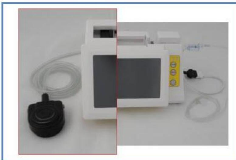
4. Collegare il pedale alla parte posteriore della console. La porta è in basso sul pannello posteriore, sotto la porta USB.
