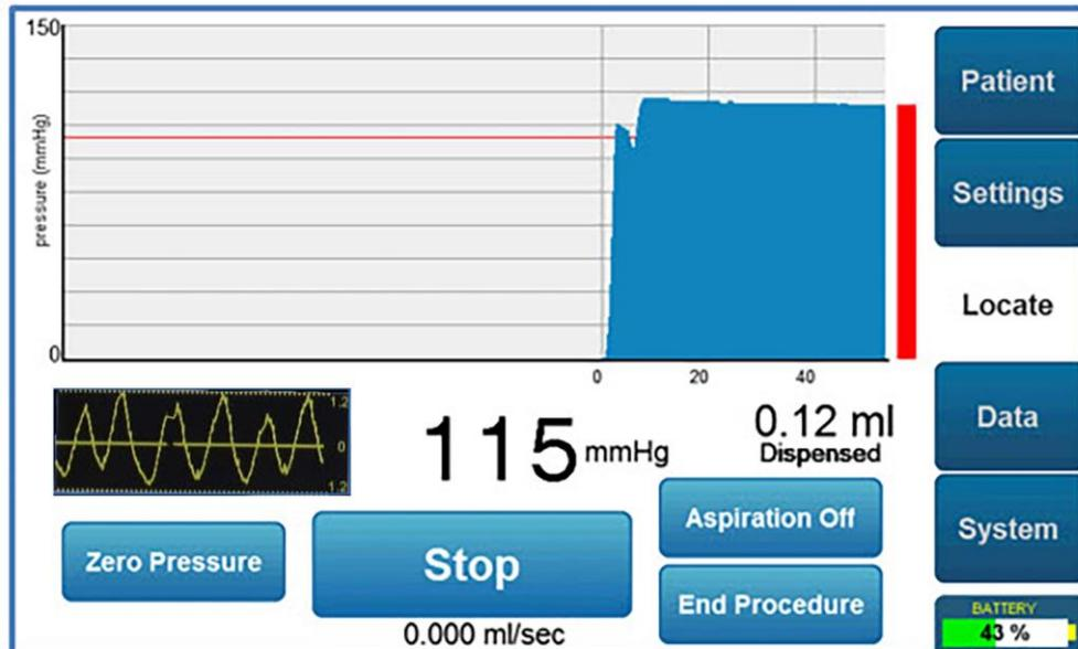
Im Verfahren Rote Zone erkennt das CompuFlo® Epidural-System Druck, der über dem benutzerdefinierten Hochschwelldruck liegt. Das System spendet die Kochsalzlösung erst, wenn der Druck auf die gelbe oder blaue Zone sinkt.
