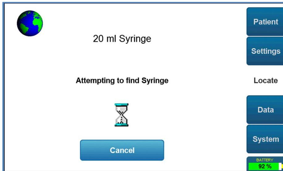
Der Plattformkolben bewegt sich vorwärts, bis er den Spritzenkolben erkennt und die Spritze findet.
