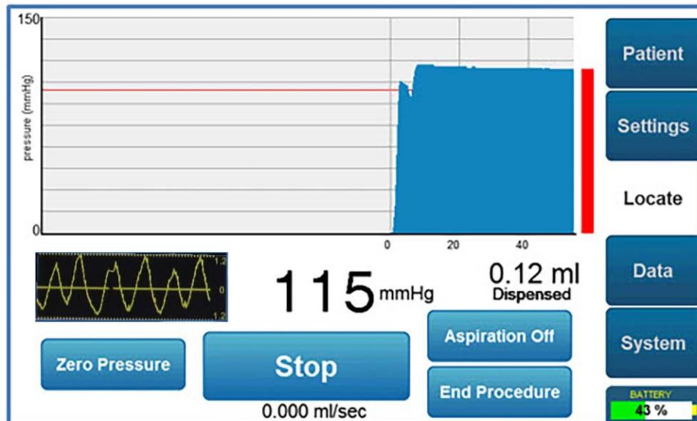
Im Verfahren Rote Zone erkennt das CompuFlo® Epidural-System Druck, der über dem benutzerdefinierten Hochschwelledruck liegt. Das System spendet die Kochsalzlösung erst, wenn der Druck auf die gelbe oder blaue Zone sinkt.
