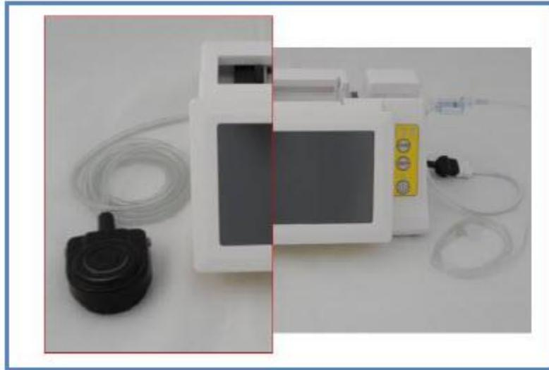
4. Befestigen Sie das Fußpedal an der Rückseite der Konsole. Der Anschluss befindet sich unten auf der Rückseite unter dem USB-Anschluss.
