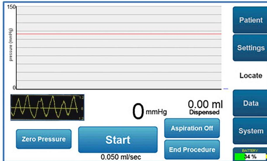
Der Fluss der Kochsalzlösung kann entweder durch Drücken der „Start“-Taste auf dem LCD-Touchscreen oder durch Drücken der „START“-Taste auf dem Bedienfeld des Systems oder durch Drücken des Fußpedals gestartet werden.
