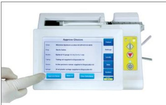
Genehmigen Sie die Auswahlmöglichkeiten. Die automatische Reinigung beginnt und füllt den Verlängerungsschlauch mit Flüssigkeit.
