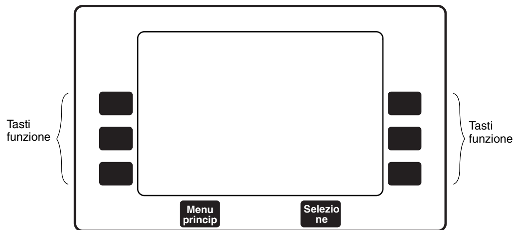
Figura 4-3. Schermo a cristalli liquidi (LCD), tasti funzione e tasti Menu principale e Selezionare paziente.
