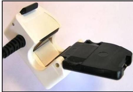
**Abbildung 11: Geöffneter Durchflusssensor**
