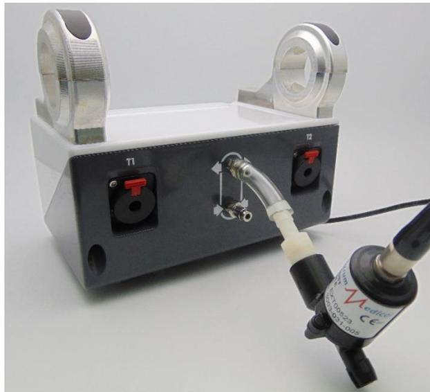
Abbildung 8: CO<sub>2</sub>-Sensor
