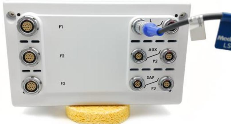
Abbildung 14: Anschluss des Füllstandssensors
